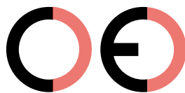
Faux marquage CE (trop éloignée)
