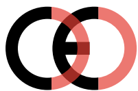
Faux marquage CE (trop proche)
